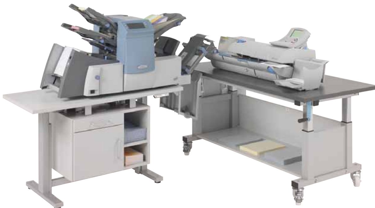
Die Abbildung zeigt eine DI425, die über eine Schnittstelle mit einem DM500-Frankiersystem verbunden ist.
